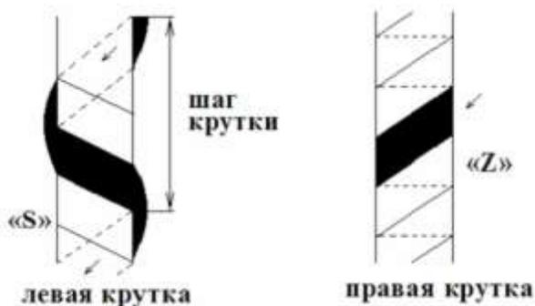
Рисунок 1 – Определение шага и направления крутки нити
