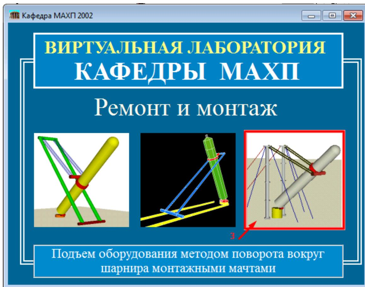
Рисунок 4.2 – Окно запуска программы виртуальной лаборатории с выбором метода монтажа колонного аппарата методом поворота вокруг шарнира
