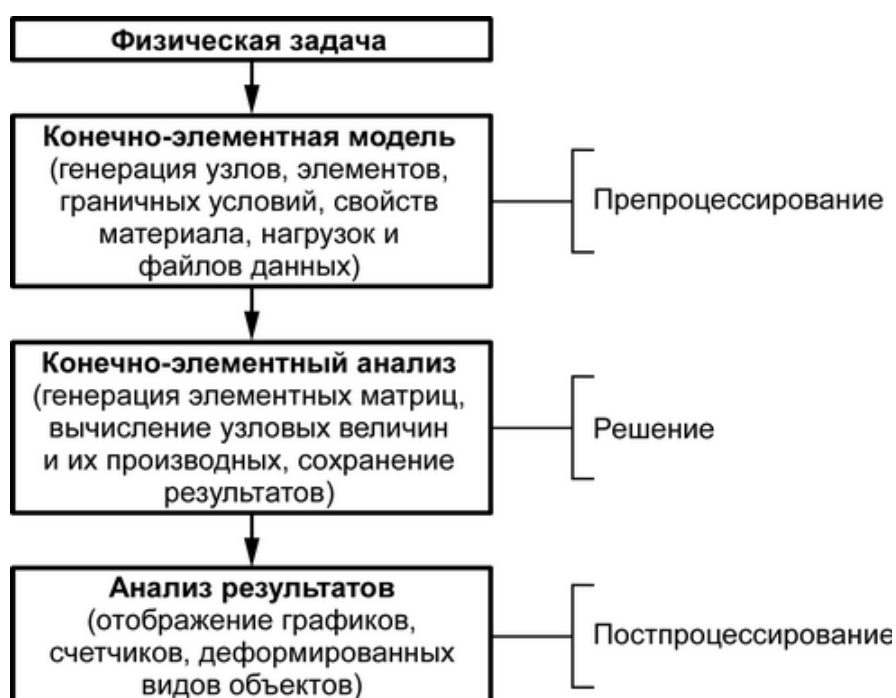
Рисунок 7 – Фазы конечно-элементного анализа в «Autodesk Simulation Mechanical»
