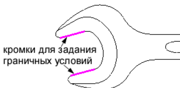
Рисунок 76 – Выбор кромок для задания граничных условий
