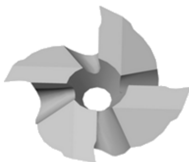
Рисунок 103 – Поверхности, подлежащие заданию на них тепловых потоков
