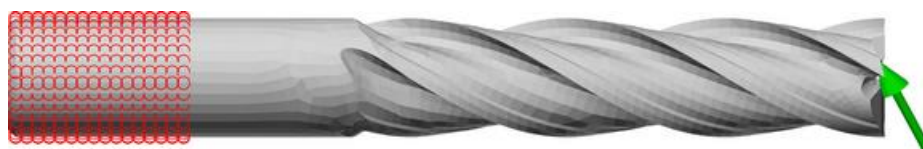
Рисунок 110 – Результат задания граничных условий и нагрузок в модели фрезы
