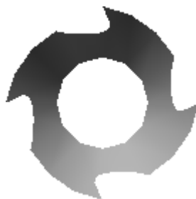
Рисунок 109 – Поверхность фрезы, подлежащая заданию на ней сил резания
