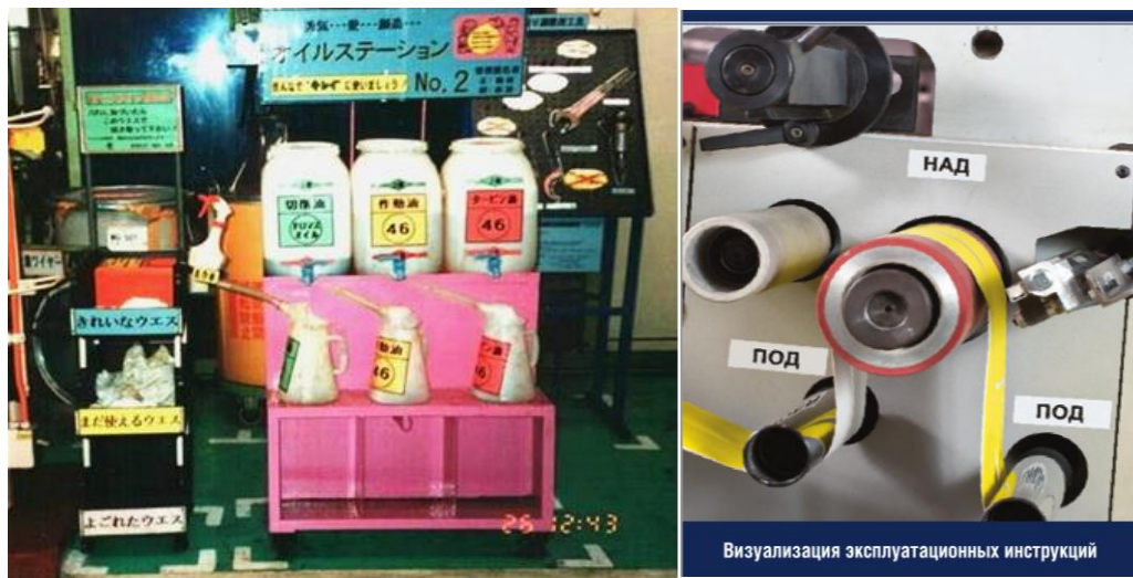
Рисунок 4.24 – Цветные указатели (Рока-юке) во вспомогательных материалах на японском предприятии и в визуализации на российском предприятии.
