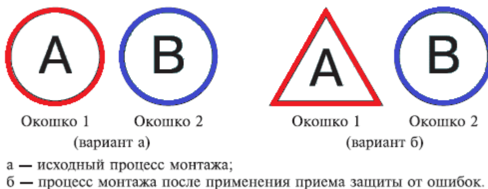
Рисунок 4.22 – Принцип действия Рока-юке для исключения ошибок подачи монтажного элемента в нужное окошко
