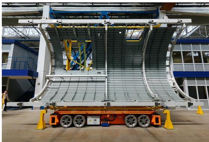
Рисунок 5.2 – Панель фюзеляжа самолета МС-21 на станции новой сборочной линии
