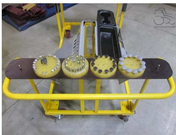
Рисунок 4.23 – Ячеистый стол для размещения всех деталей комплекта без потерь
