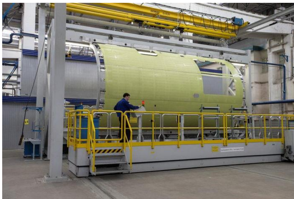
Рисунок 5.3 – Первые компоненты самолета МС-21 на станции новой сборочной линии
