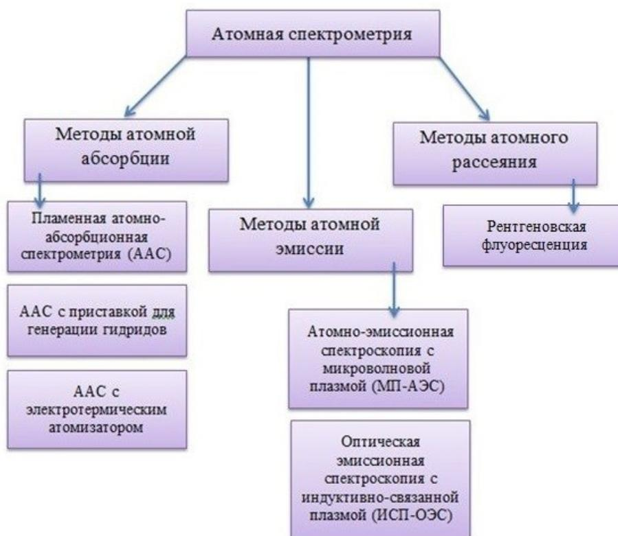
Рисунок 16 – Классификация атомной спектрометрии
