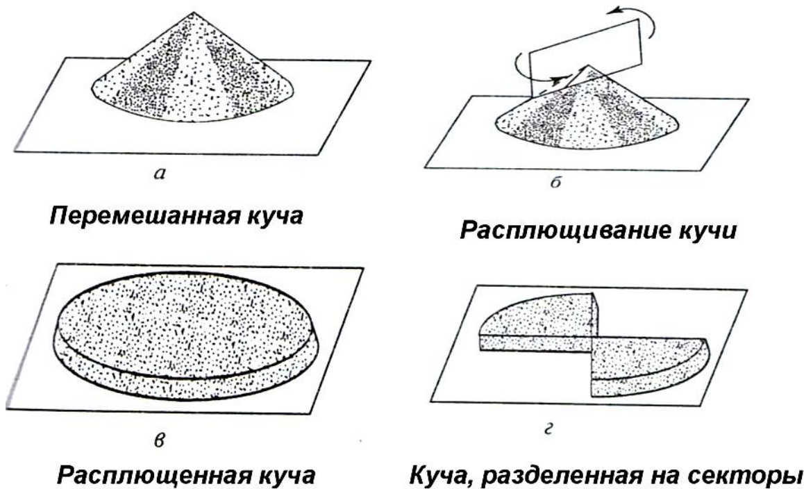
Рисунок 1.5 – Деление навески сырья в ручную способом квартования
