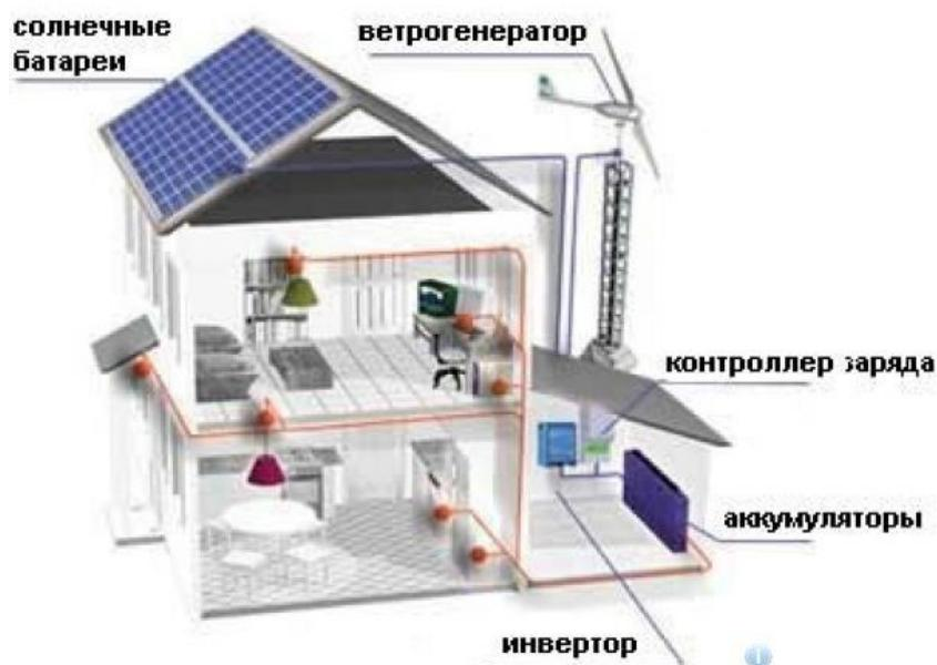
Рисунок 39 – Комбинированная система получения энергии в жилом доме
