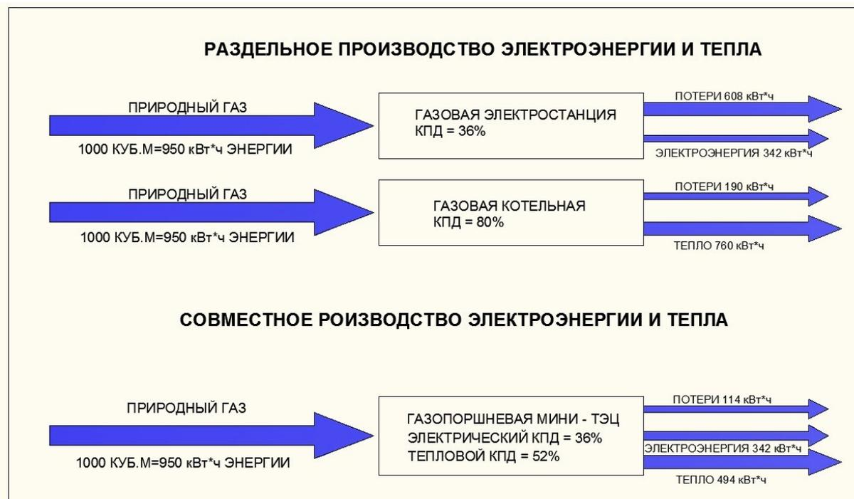
Рисунок 41 – Энергетическая схема работы газопоршневой мини-ТЭЦ
