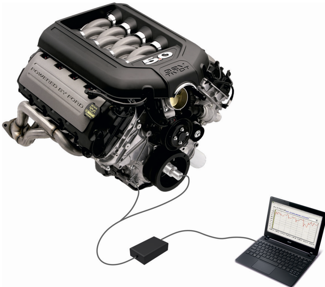
Рисунок 3.6 - Подсоединение АСОСП к двигателю
