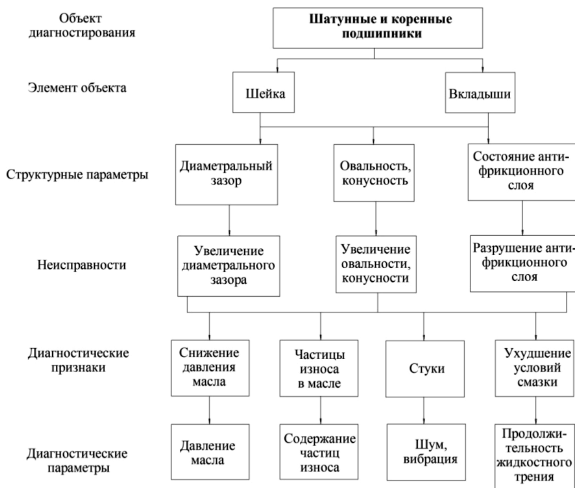
Рисунок 1.2 – Схема структурно-следственных связей системы диагностирования подшипников скольжения
