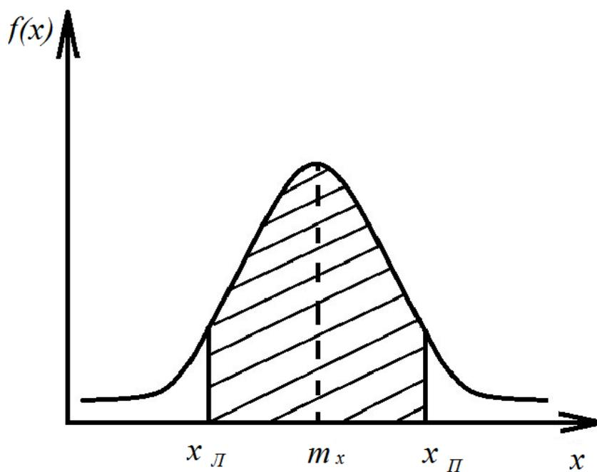
Рисунок 8 – Доверительный интервал
