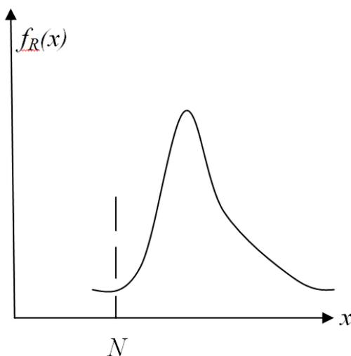
Рисунок 2 – Плотность распределения несущей способности  $R$
