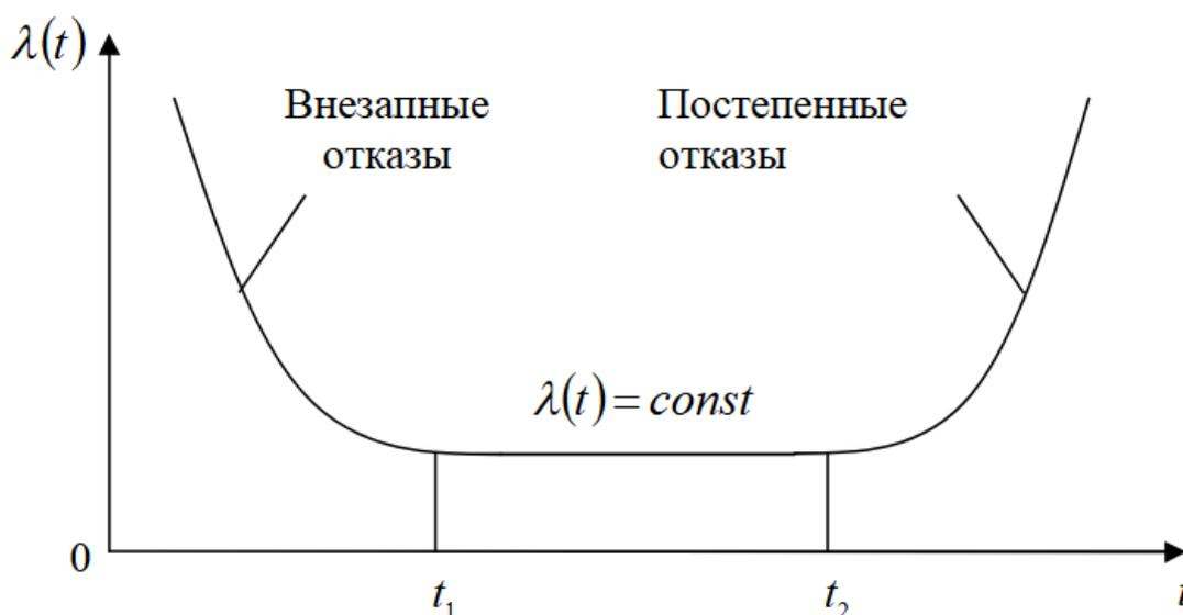
Рисунок 2 – Кривая интенсивности отказов
