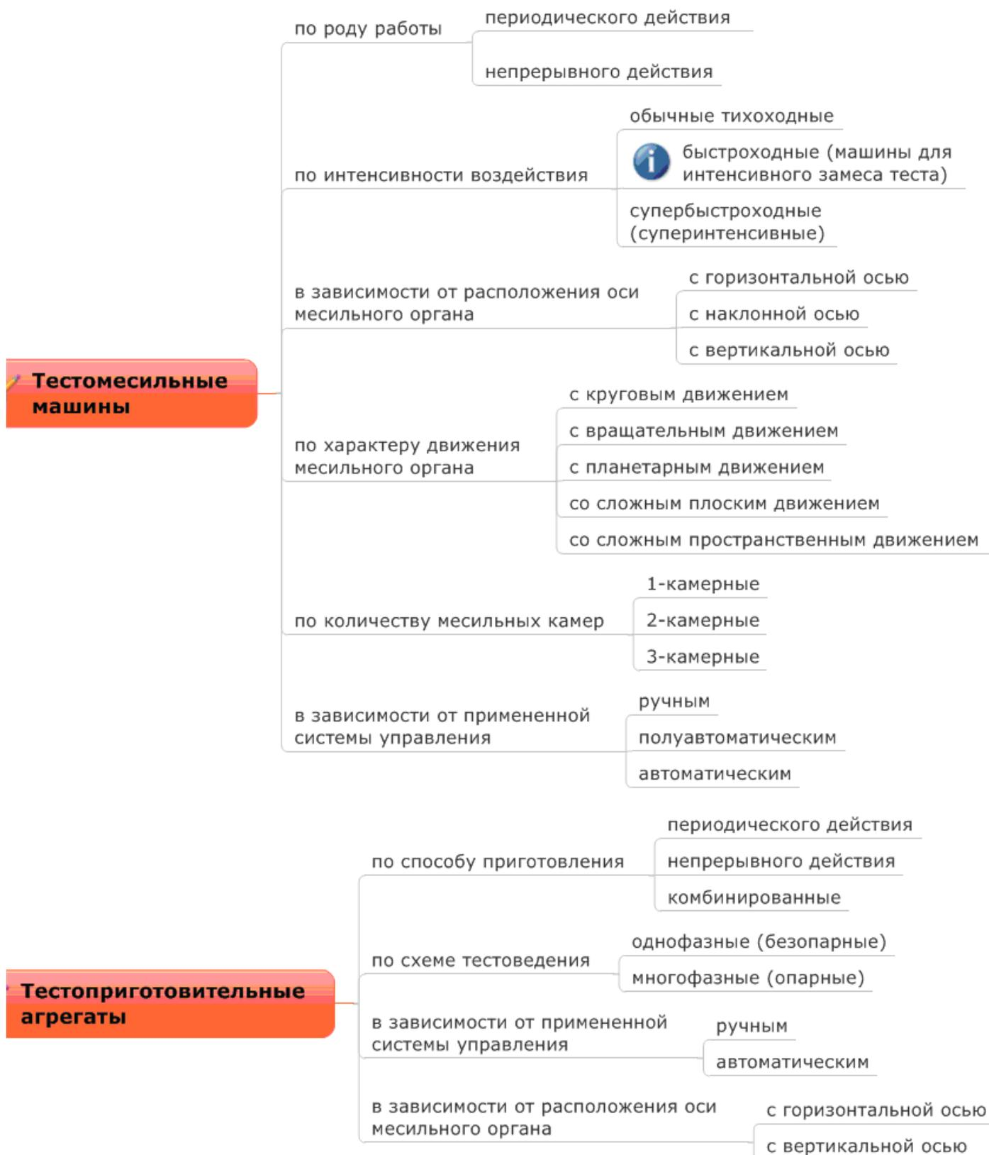
Рисунок 1.1 – Общая классификация тестомесильных машин и тестоприготовительных агрегатов
