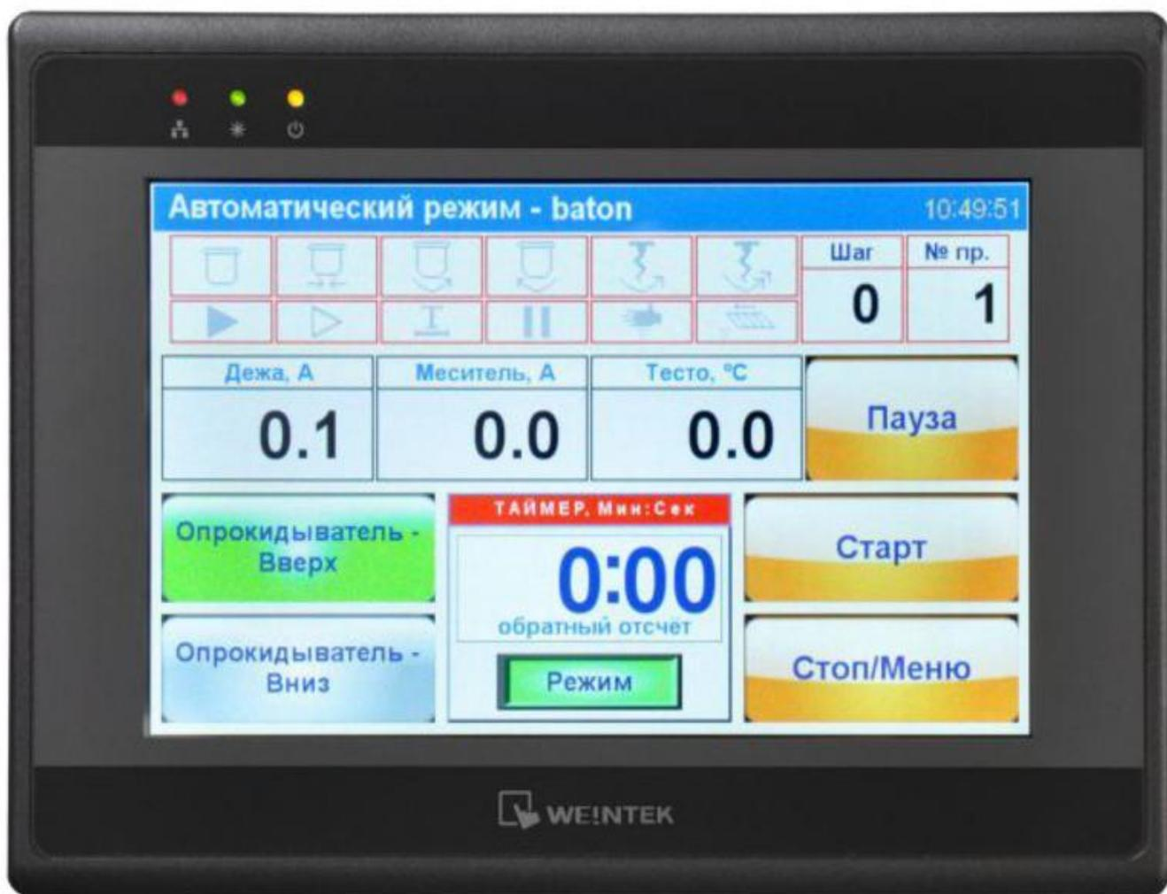
Рисунок А.3 – Внешний вид пульта дистанционного управления для тестоприготовительного агрегата
