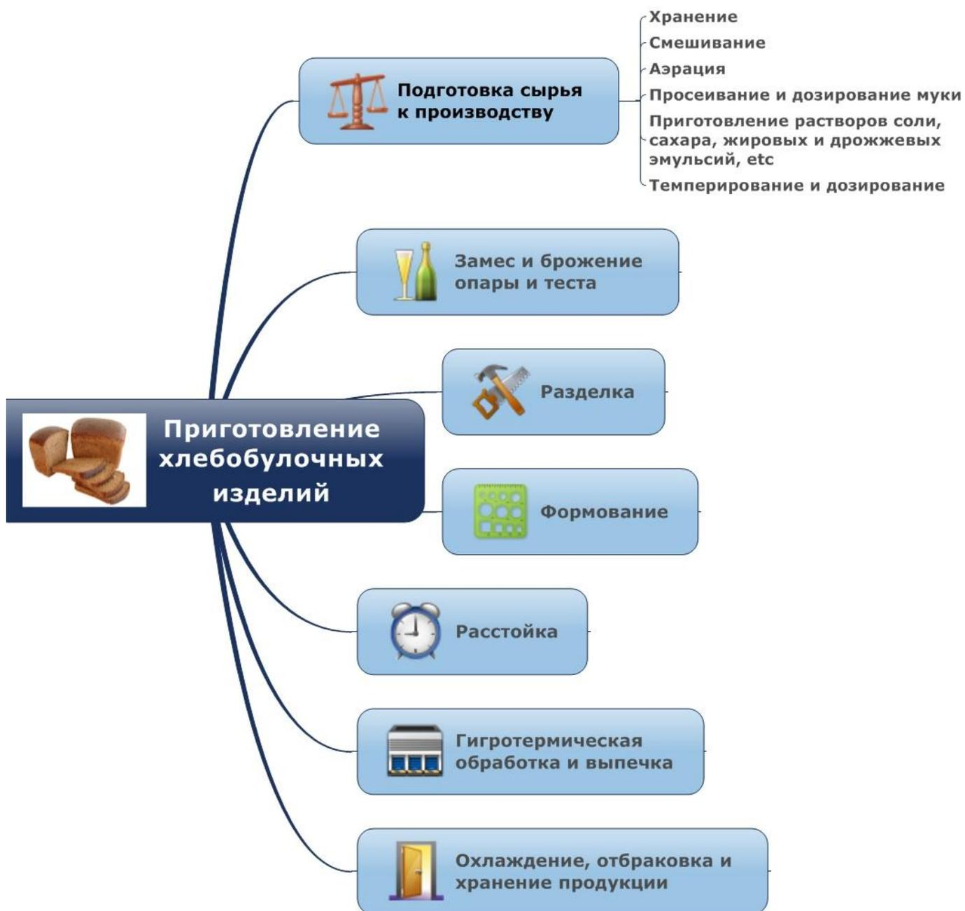
Рисунок А.2 – Классификация технологических операций для производства хлебобулочных изделий
