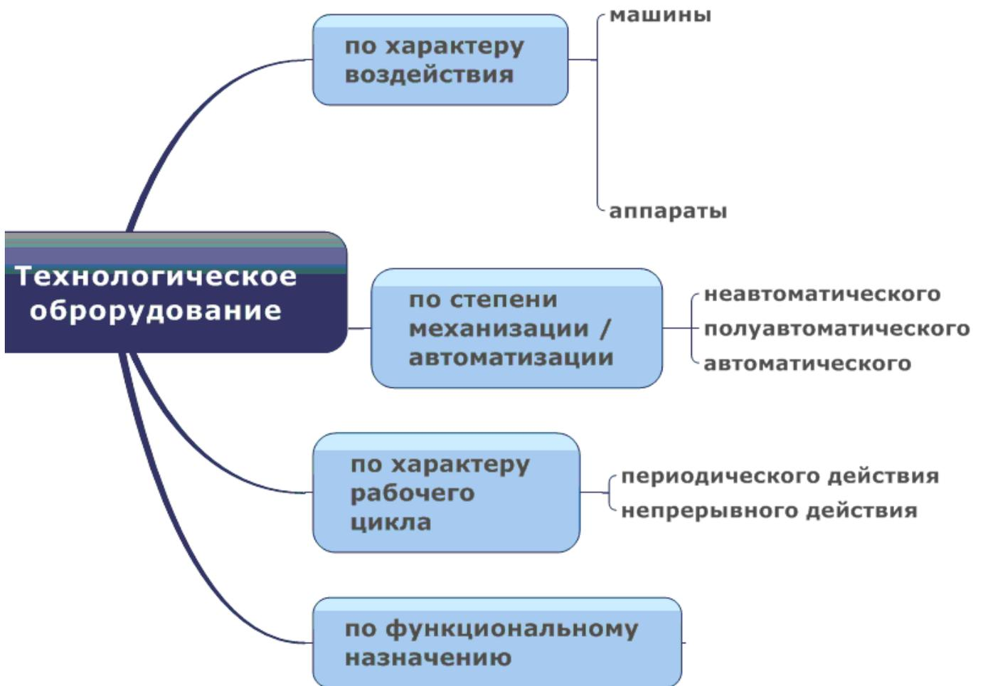
Рисунок А.1 – Краткая классификация технологического оборудования
