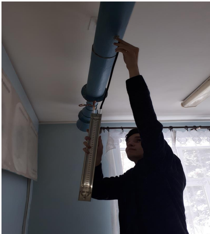
Рисунок - 4 Схема подключения мановакуумметра к лабораторной вентиляционной установке
