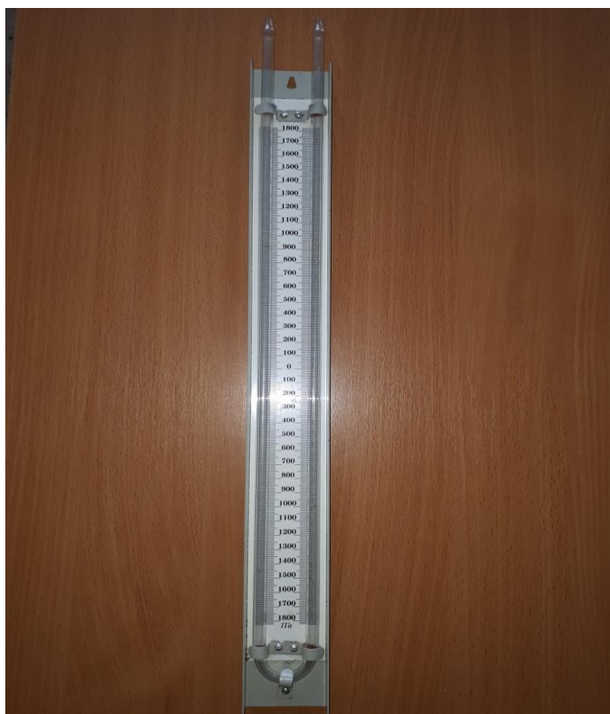
Рисунок -3 Двухтрубный мановакуумметр
