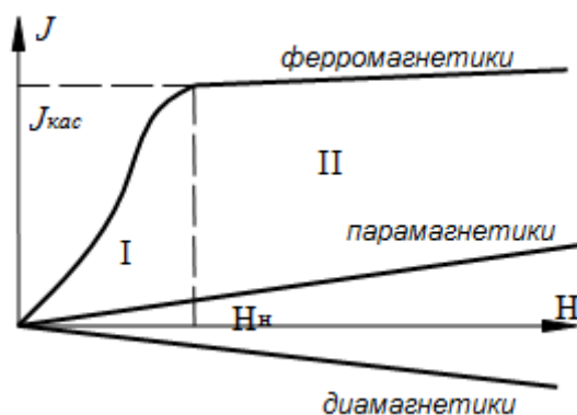
Рисунок 4 – Зависимость намагниченности магнетика от напряженности внешнего поля
