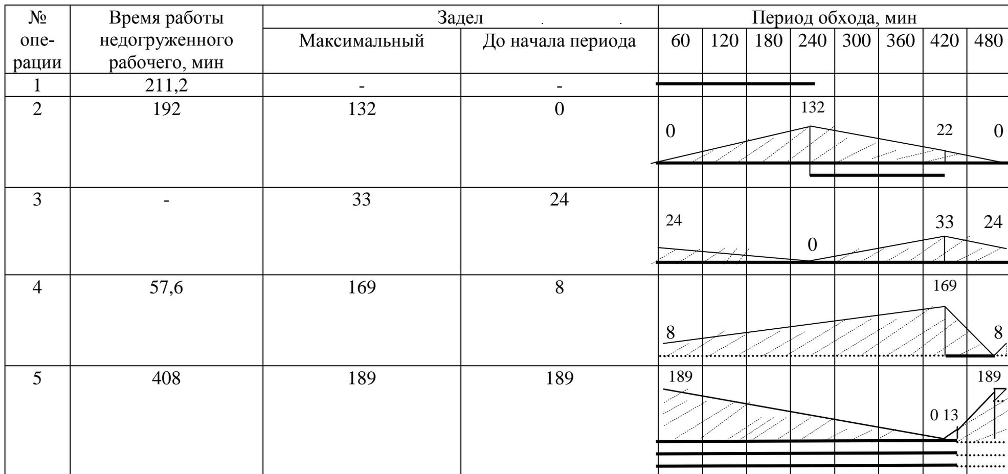
Рисунок 4 - График движения оборотных заделов на прерывно-поточной линии
