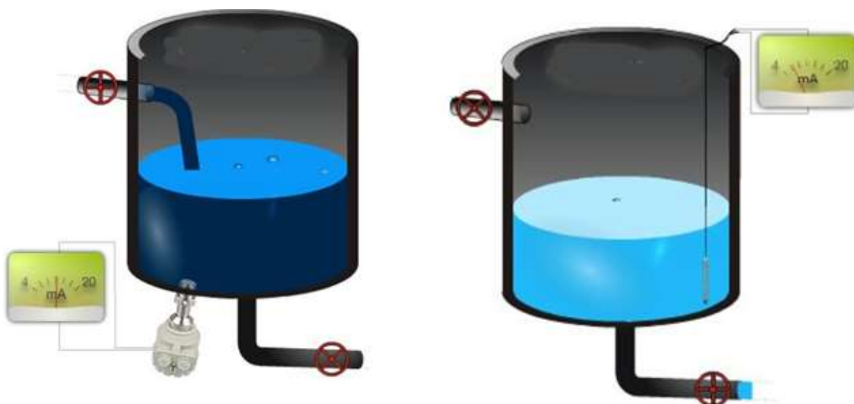
Рисунок 5.14 – Резервуары с врезным и погружным гидростатическими датчиками уровня
