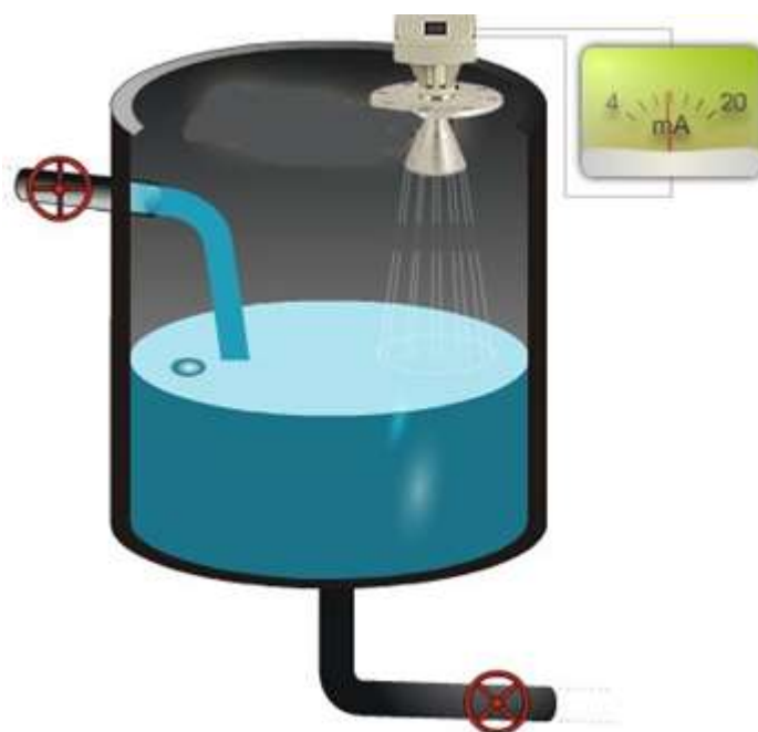
Рисунок 5.26 – Емкость с микроволновым радарным уровнемером
