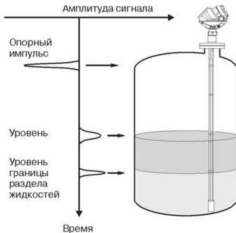
Рисунок 5.30 – Вид распространения радарного импульса в измерительной среде
