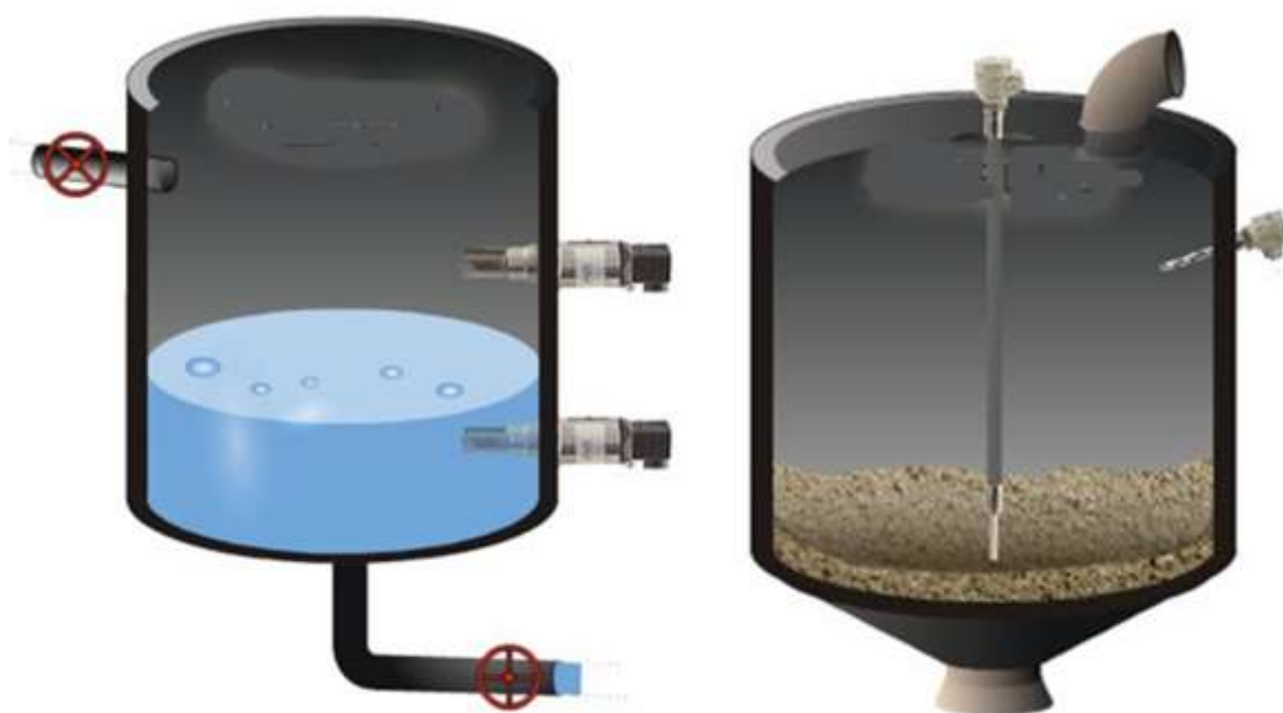
Рисунок 5.23 – Ёмкости с вибрационными сигнализаторами уровня
