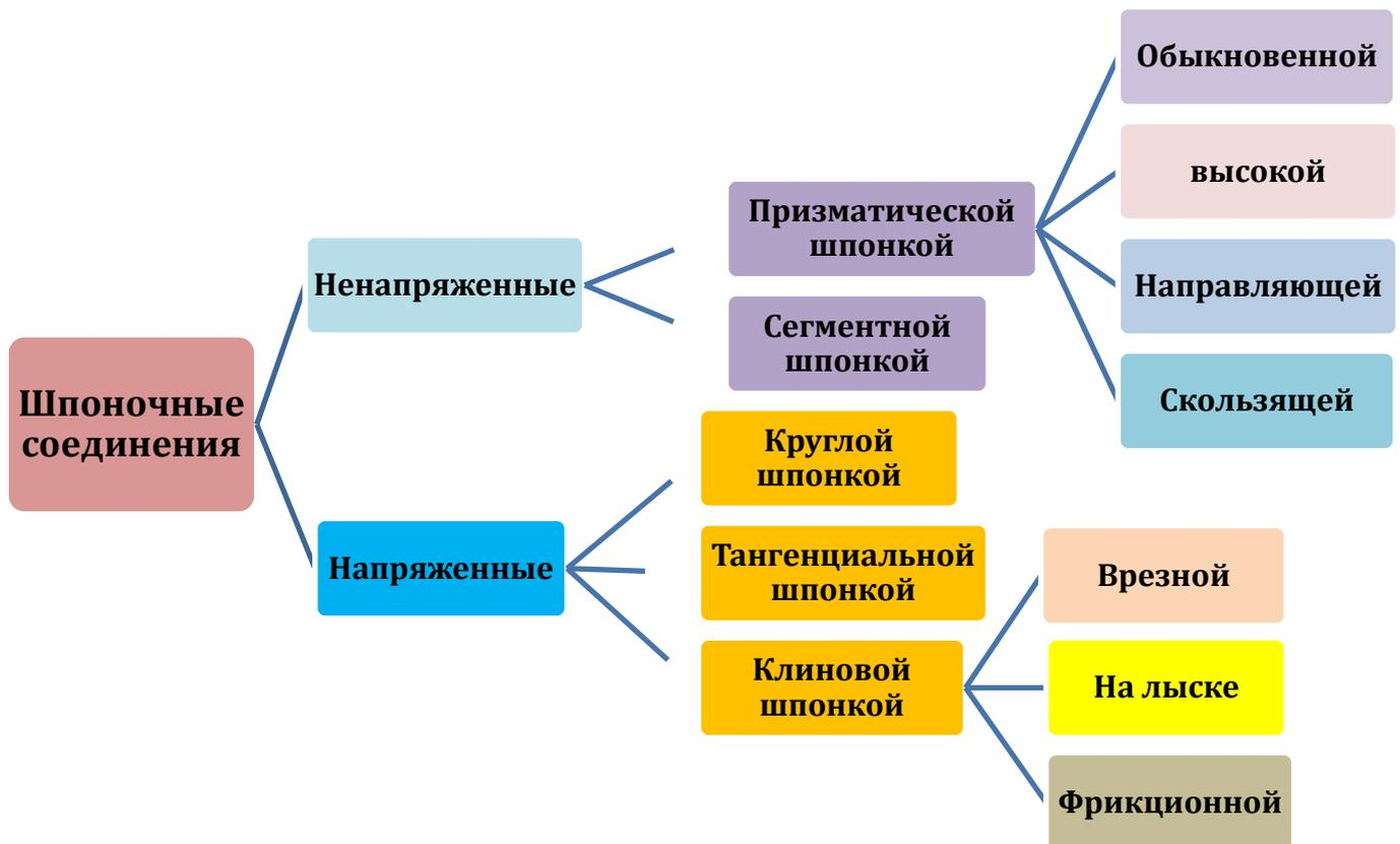
Рисунок 1.5 – Классификация шпоночных соединений
