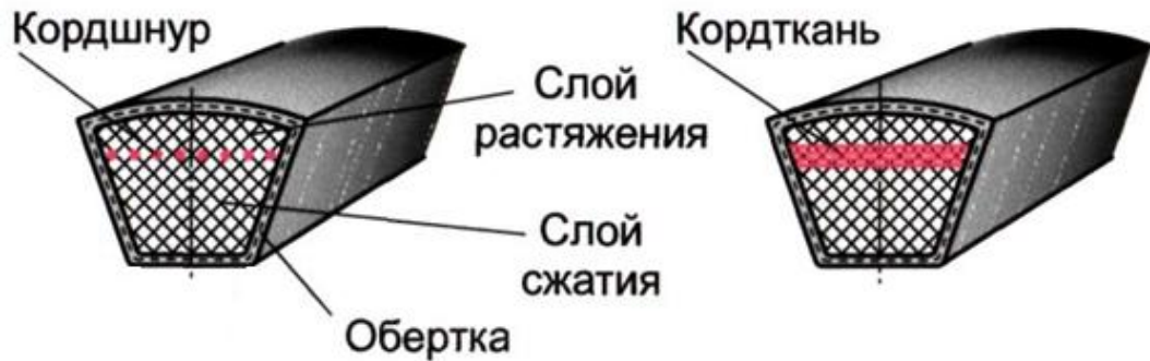
Рисунок 1.3 – Строение приводного ремня
