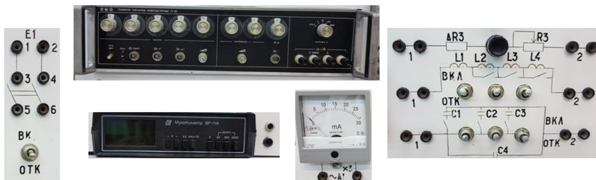
Рисунок 5.4 – Элементы и измерительные приборы универсального стенда, используемые в лабораторной работе
