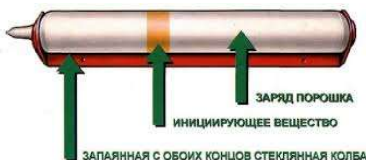
Рисунок 8 – Схема установки огнетушителя ОСП
