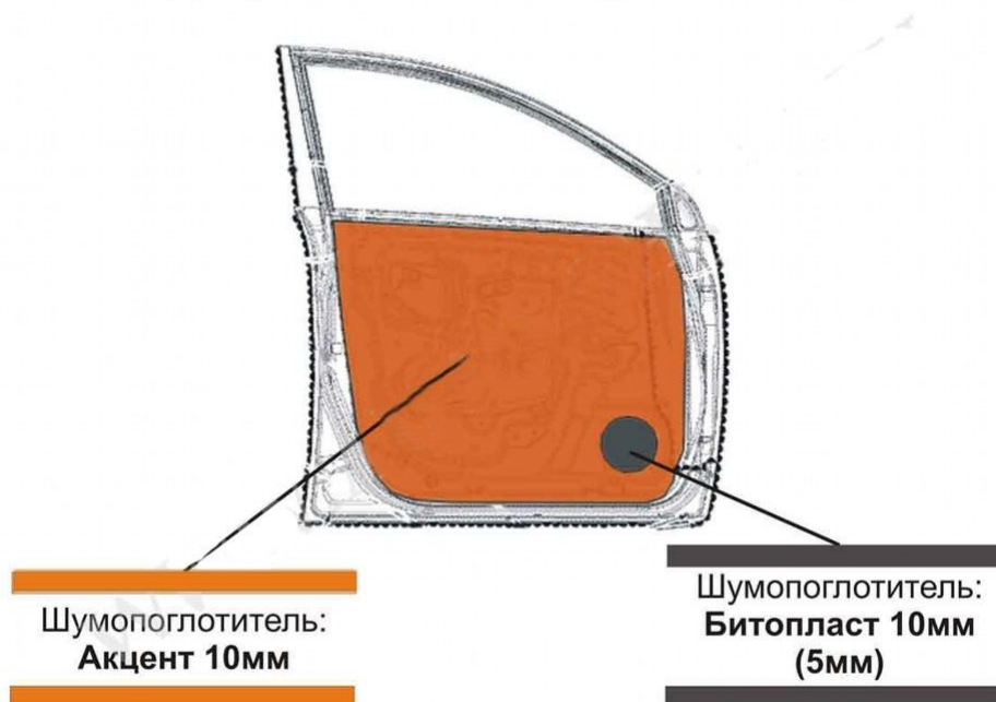
Рисунок 30 – Шумоизоляция дверей
