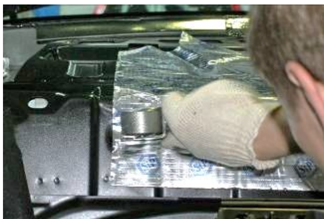
Рисунок 42 – Прокатка вибродеталей монтажным валиком
