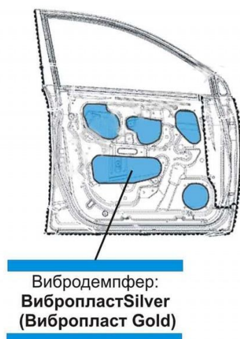
Рисунок 28 – Виброизоляция наружной поверхности дверей
