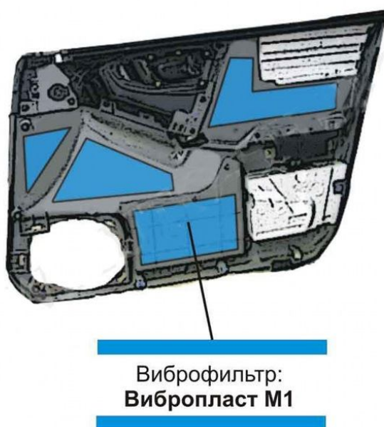
Рисунок 31 – Виброизоляция обшивки дверей
