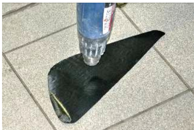
Рисунок 43 – Прогрев вибродетали промышленным феном
