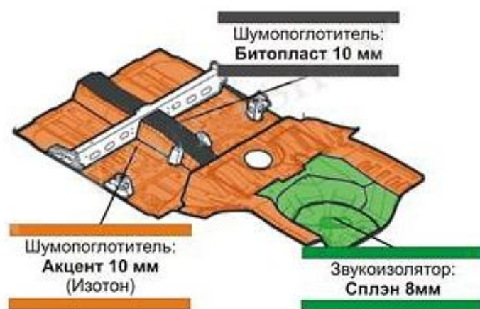
Рисунок 33 – Шумоизоляция пола салона
