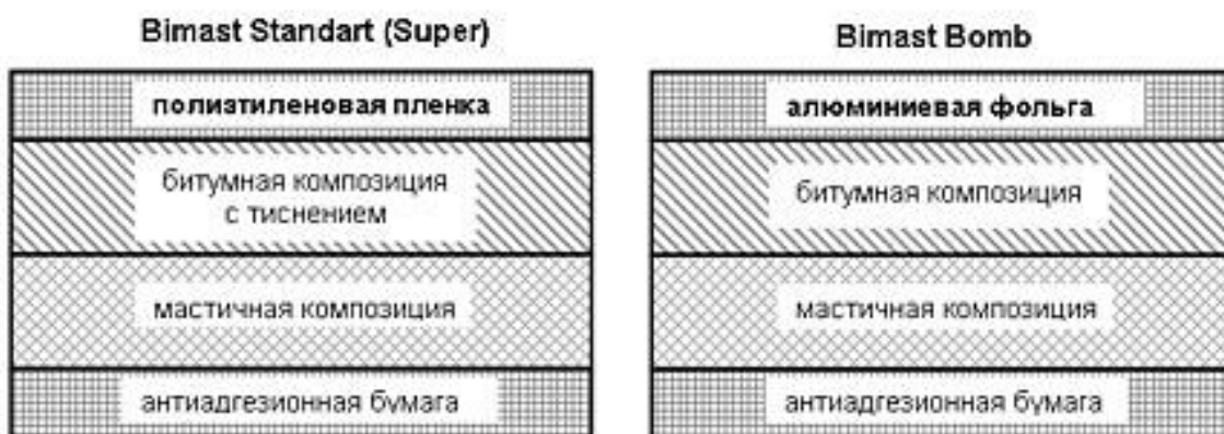
Рисунок 10 – Конструкция виброизоляционного материала «Бимаст»
