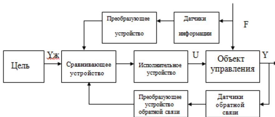
Рисунок 36 – Структурная схема комбинированного управления
