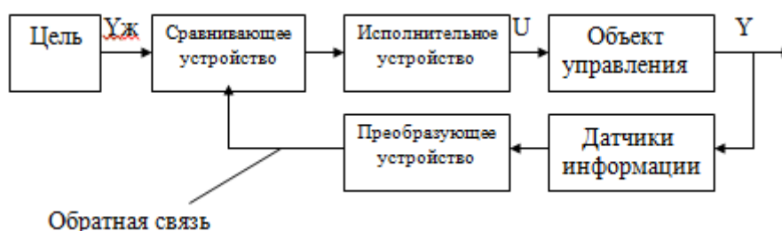
Рисунок 34 – Структурная схема управления с обратной связью
