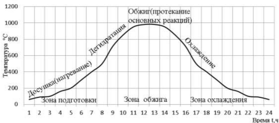
Рисунок 1.12 – График технологического процесса производства керамического кирпича в туннельной печи
