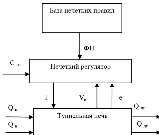
ФП – функция принадлежности,  $C_{з.т.}$  – заданный температурный режим,  $i$  – ток задания частоты,  $e$  – ошибка между действительным и заданным режимом,  $V_e$  – скорость изменения ошибки,  $Q_{пг}$  – расход природного газа,  $Q_{в}$  – расход атмосферного воздуха,  $Q_{пг}$  – расход нагретого газа,  $Q_{дг}$  – расход дымовых газов
