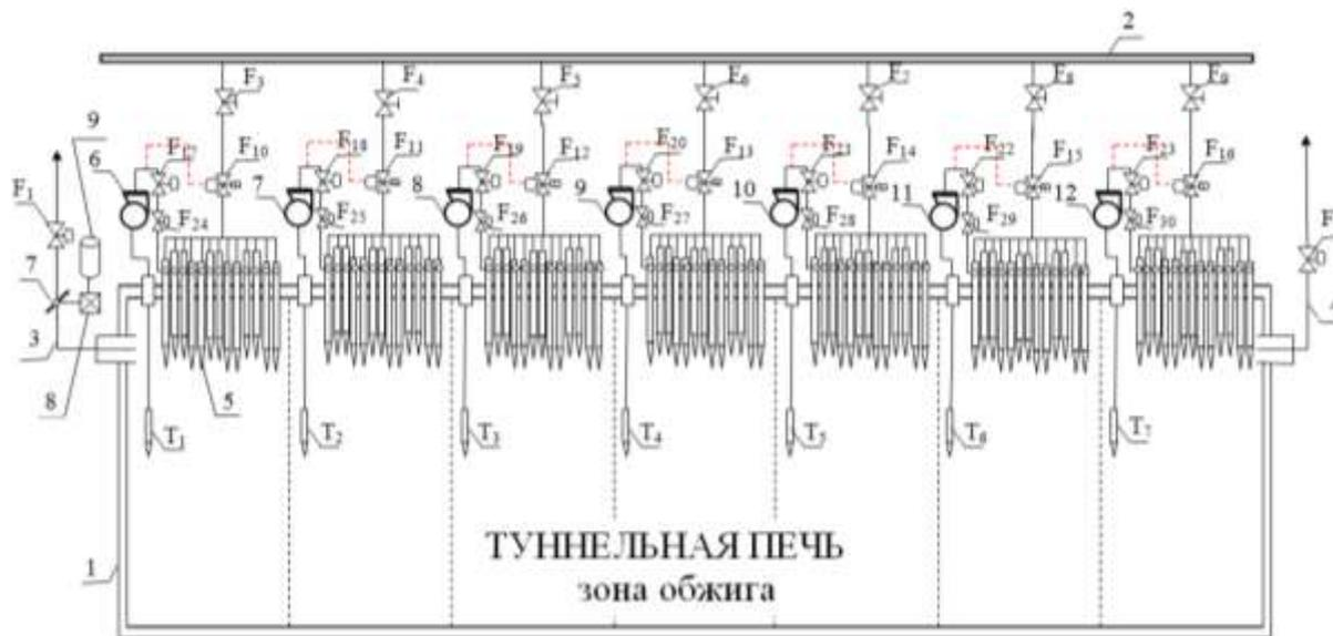
Рисунок 3.18 – Схематическая конструкция зоны обжига керамического кирпича туннельной печи
