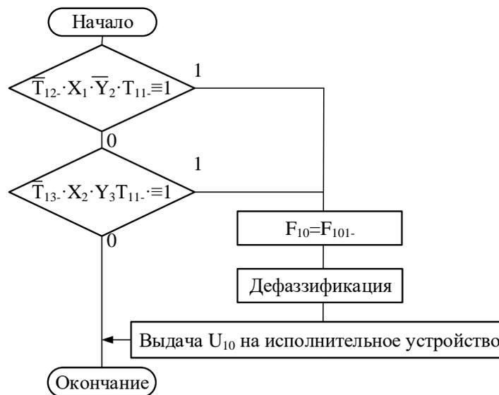
Рисунок 4.6 – Логическая схема отработки продукционного правила (4.1)
