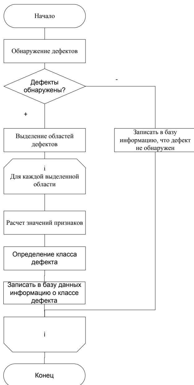
Рисунок 4.7 – Алгоритм обработки сформированного изображения
