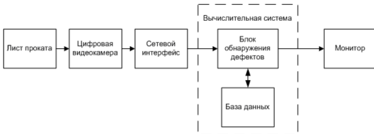
Рисунок 1.5 – Архитектура СКЗ обнаружения поверхностных дефектов
