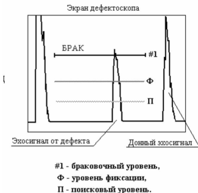
Рисунок 1.13 – Принцип работы системы идентификации эхометода
