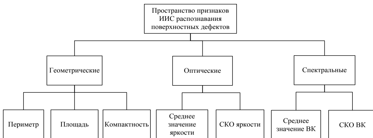
Рисунок 1.11 – Расширенное пространство признаков поверхностных дефектов
