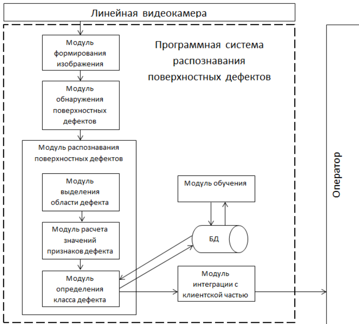
Рисунок 4.5 – Схема взаимодействия модулей в процессе работы системы распознавания
