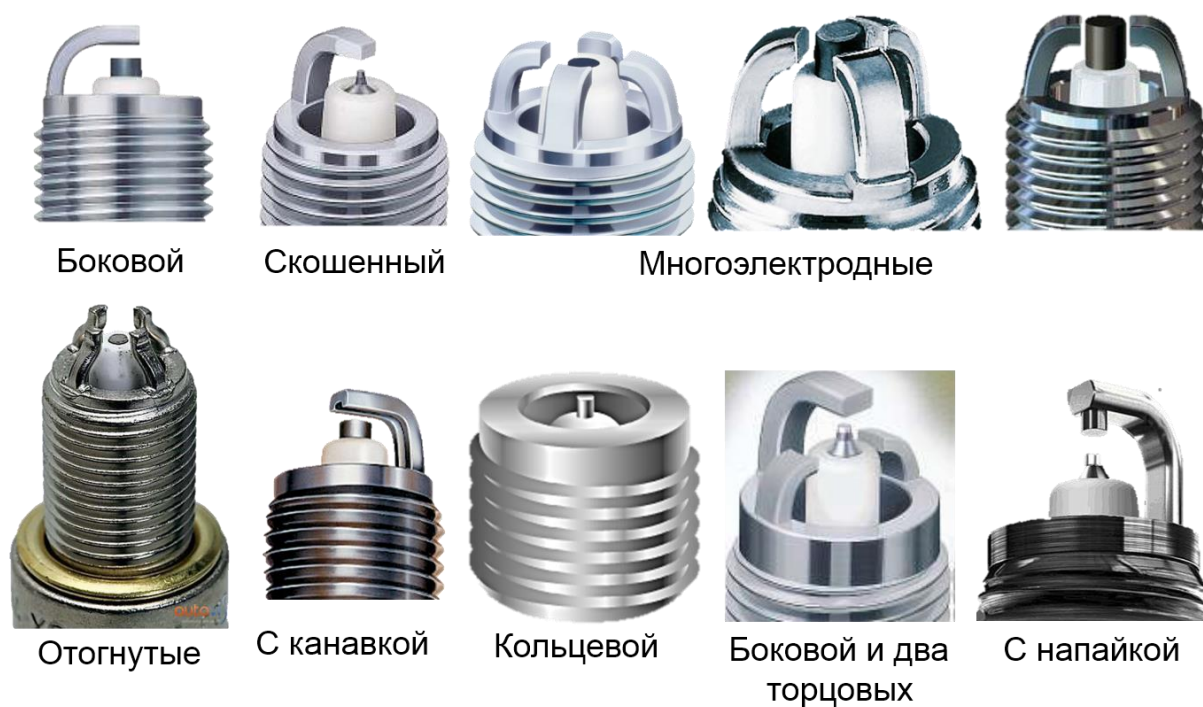
Рисунок 19 – Форма массовых электродов свечей зажигания
