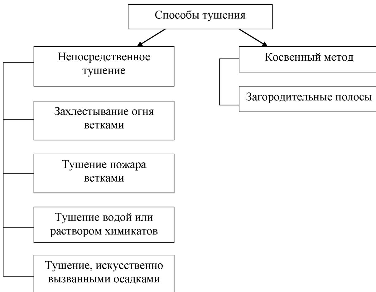
Рисунок 19 – Способы тушения пожаров
