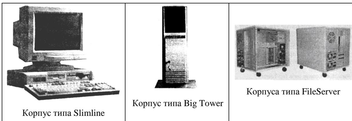
Рисунок 1 - Типы корпусов системных блоков
