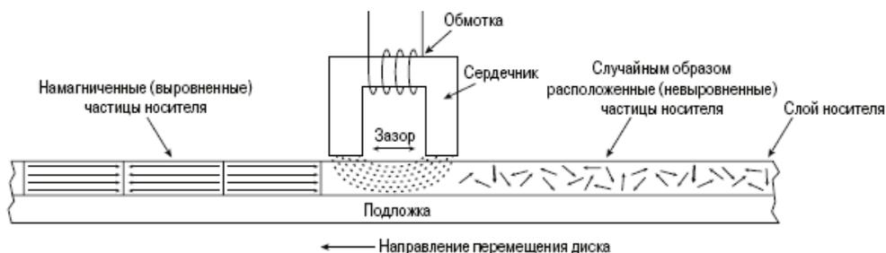
Рисунок 16 – Головка чтения/записи
