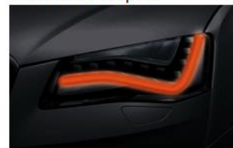
Модуль статического освещения поворотов
