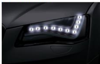
Модуль освещения при движении по магистралям
