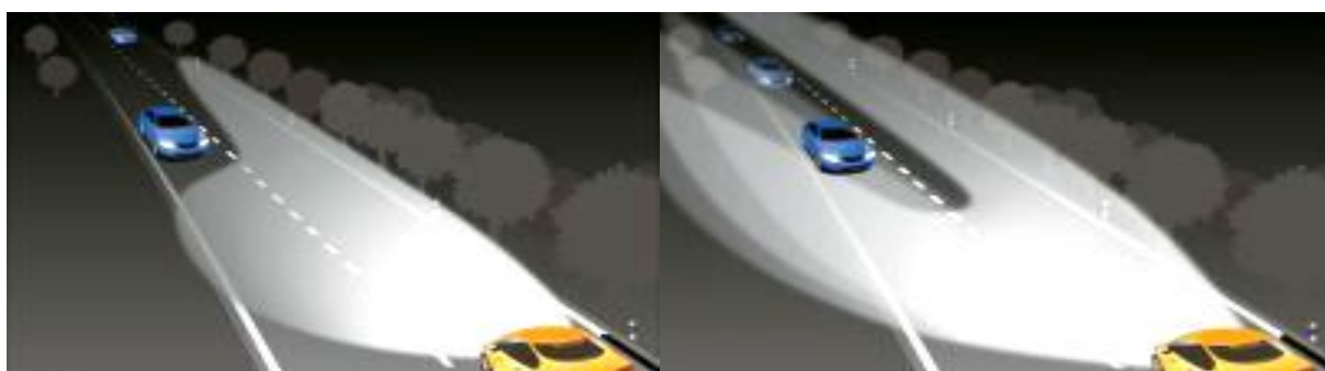
Рисунок 61 – Работа адаптивного освещения при встречном разъезде
