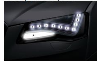
Модуль статического освещения поворотов
