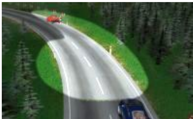
Рисунок 62 – Работа адаптивного освещения при прохождении поворота
