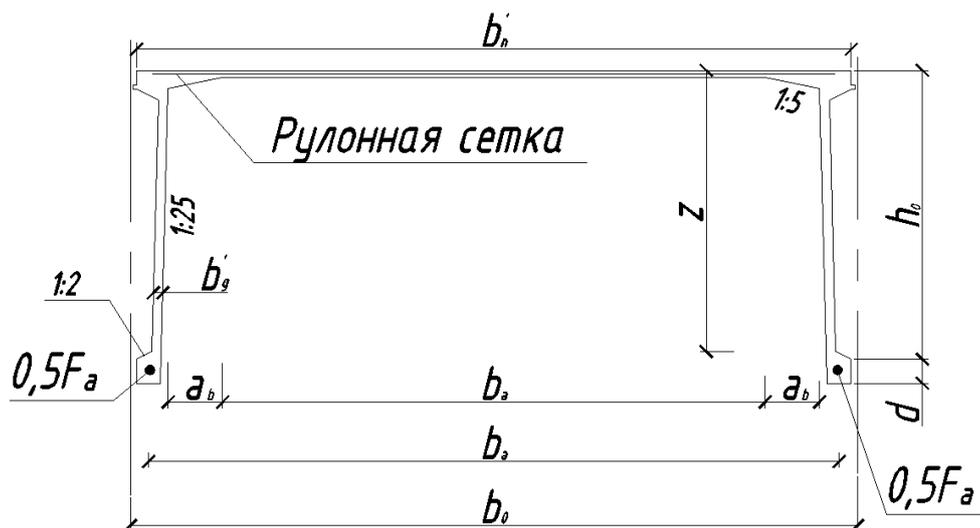
Рисунок 2.3 – Поперечное сечение панели-оболочки КЖС
