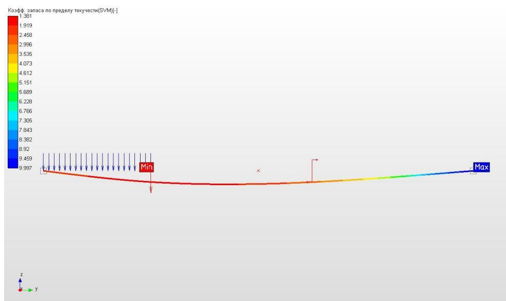
Рисунок 6.8 – Коэффициент запаса прочности по пределу текучести
