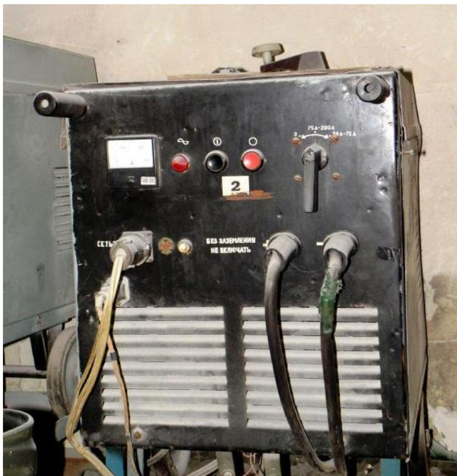
Рисунок 4 – Внешний вид сварочного выпрямителя ВД 201УЗ
