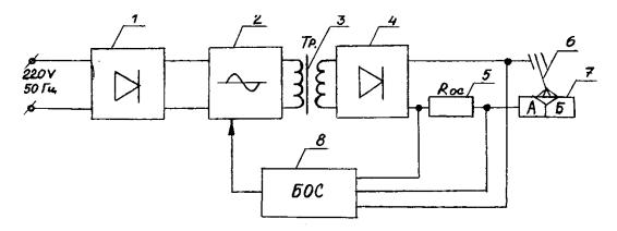
1 — низкочастотный выпрямитель; 2 — инвертор; 3 — высокочастотный трансформатор; 4 — высокочастотный выпрямитель; 5 — сопротивление обратной связи; 6 — электрод; 7 — заготовка; 8 — блок обработки сигналов
