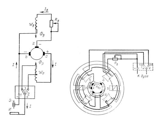
Рисунок 8 — Принципиальная электрическая схема и устройство магнитной системы четырех полюсного генератора с самовозбуждением
