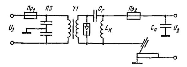
Рисунок 2 – Электрическая схема осциллятора последовательного включения
