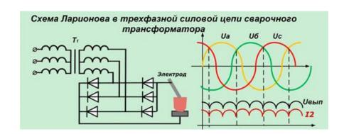
а – упрощённая схема; б – осциллограмма трёхфазного напряжения; в – осциллограмма трёхфазного выпрямленного напряжения
