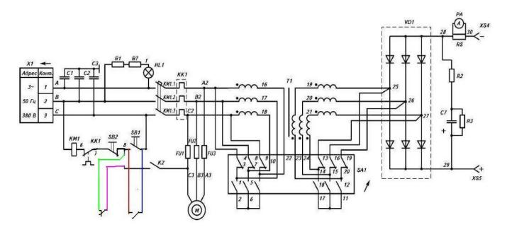
Рисунок 5 – Схема электрическая принципиальная сварочного выпрямителя ВД 201 УЗ
