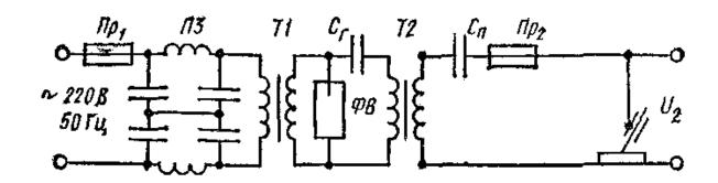
Рисунок 1 — Электрическая схема осциллятора, включенного в сварочную цепь параллельно
