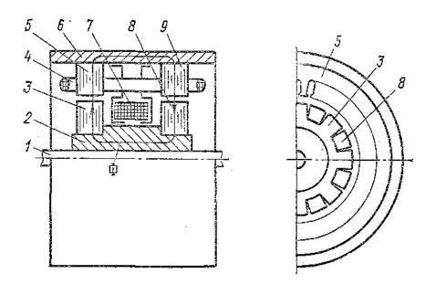
1 – вал; 2 – массивная втулка на валу; 3, 8 – пакеты железа ротора; 4 – обмотка якоря; 6,9 – пакеты железа статора; 6 – станина; 7 – обмотка возбуждения, прикрепленная к станине; Ф – основной магнитный поток
