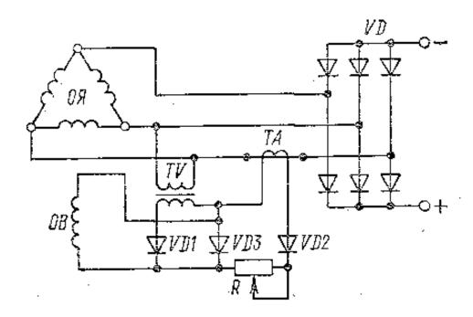
OЯ – обмотка якоря; OВ – обмотка возбуждения; TV, TA – трансформаторы напряжения и тока; VD – силовой вентильный блок; VD1, VD2, VD3 – диоды в цепи возбуждения; R – реостат для управления значением сварочного тока
