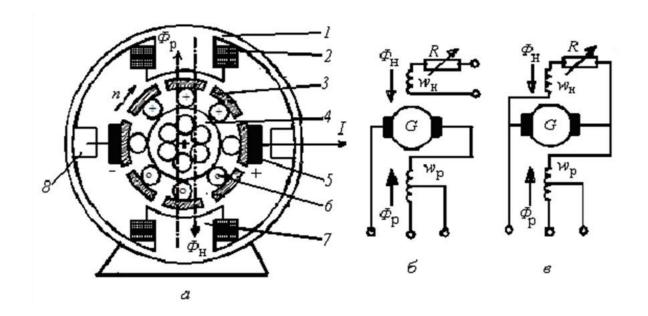
а – конструктивная схема; б – схема независимого возбуждения; в – схема параллельного возбуждения: 1 – статор; 2 – намагничивающая обмотка; 3 – коллекторная пластина; 4 – ротор; 5 – щетка; 6 – обмотка якоря; 7 – главный полюс; 8 – дополнительный полюс; Фн – намагничивающий поток; Фр – размагничивающий поток; wн – обмотка возбуждения намагничивающая; wp – обмотка размагничивающая
