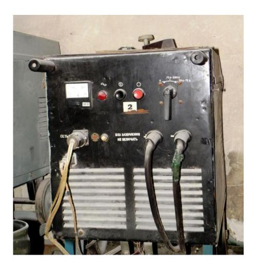
Рисунок 4 – Внешний вид сварочного выпрямителя ВД 201У3
