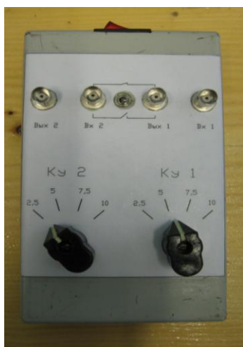
Рисунок 2 – Лицевая панель и вид монтажа внутри корпуса импульсного усилительного модуля
