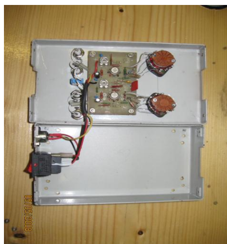
Рисунок 2 – Лицевая панель и вид монтажа внутри корпуса импульсного усилительного модуля
