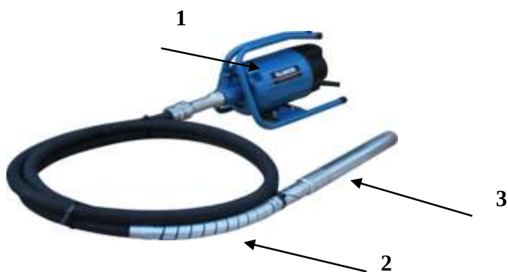
1 — электродвигатель, 2 — гибкий вал, 3 — вибронаконечник
