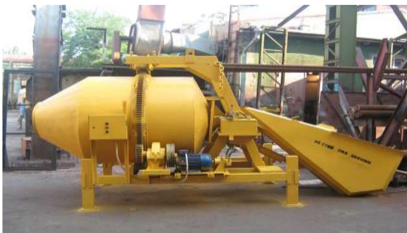
Рисунок 5– Бетоносмеситель циклический гравитационный на раме с гидравлическим скипом
