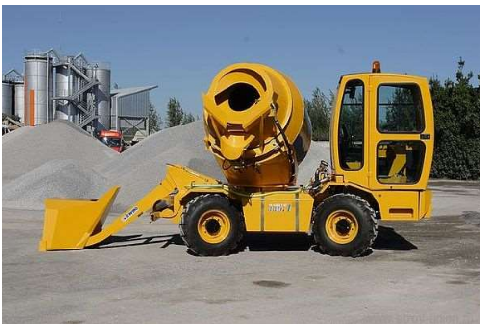
Рисунок 7 – Автобетоносмеситель с самозагрузкой
