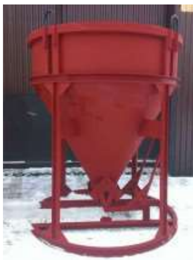
Рисунок 18 – Бадья для бетона типа «бункер»
