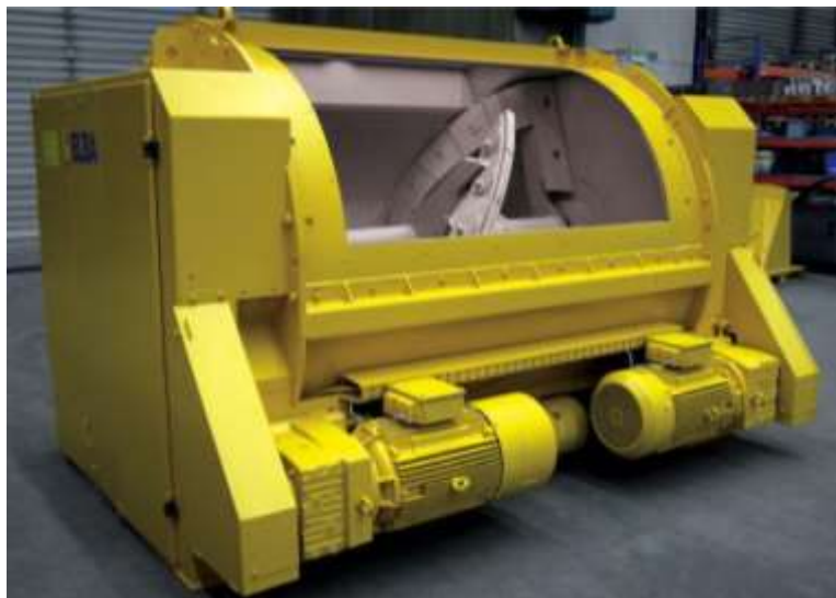
Рисунок 4 – Стационарный бетоносмеситель принудительного действия
