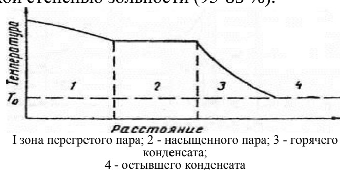
Рисунок 5.2 - Схема распределения температуры в пласте при нагнетании пара
