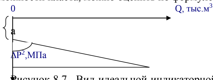
Рисунок 8.7 – Вид идеальной индикаторной диаграммы для идеального газового пласта
