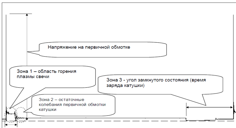
Рисунок 32 –Разделение времени работы элементов системы зажигания на этапы
