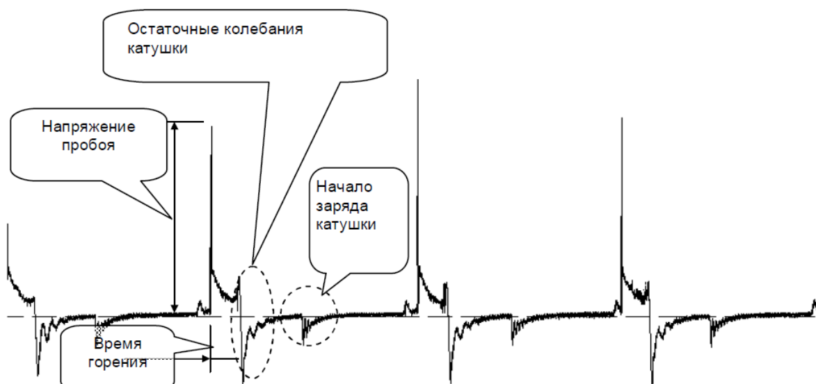
Рисунок 38 – Изменения напряжения во вторичной обмотке катушки зажигания с течением времени
