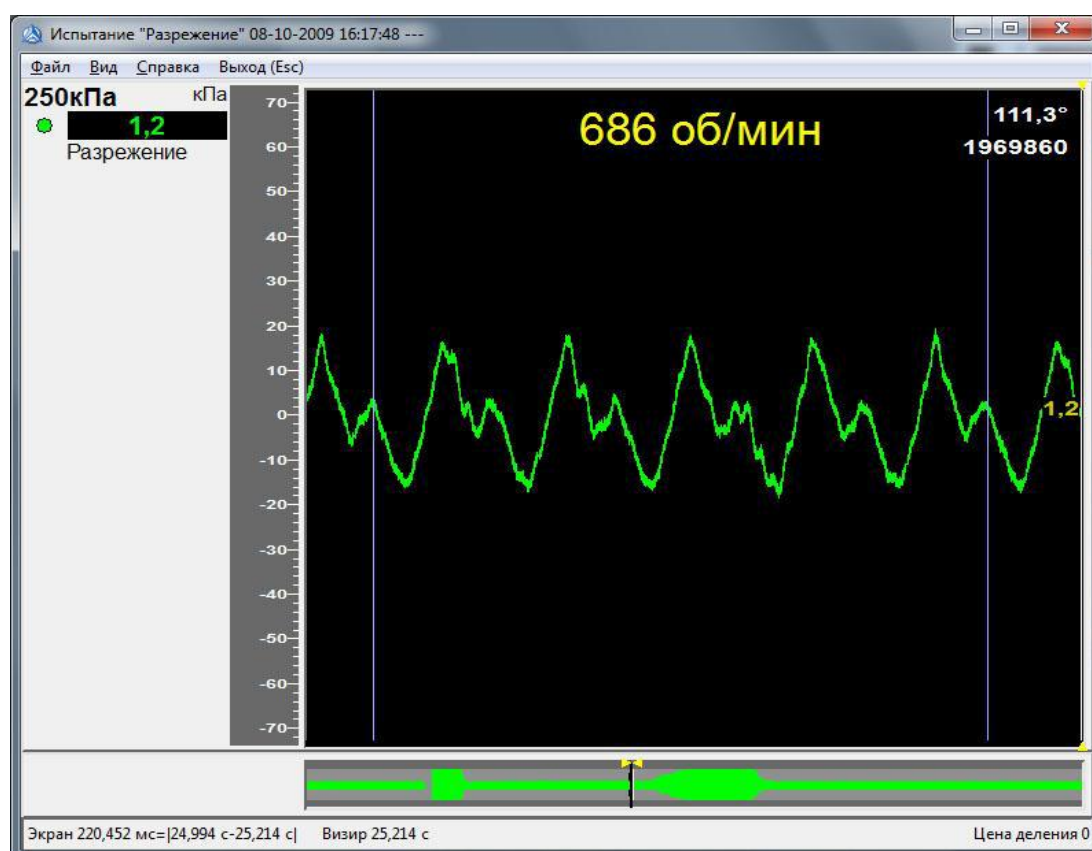
Рисунок 41 – Измерение разрежения и пульсаций давления во впускном коллекторе
