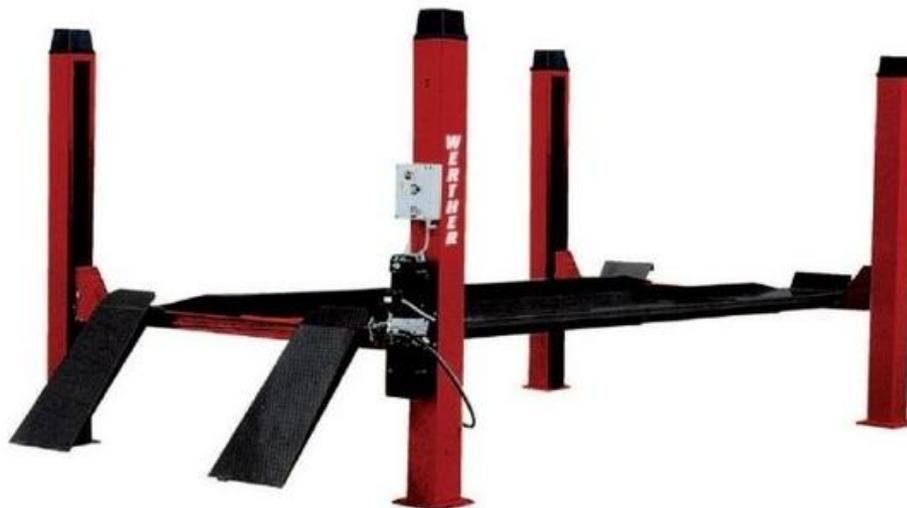
Рисунок 13 – Внешний вид четырёхстоечного подъёмника
