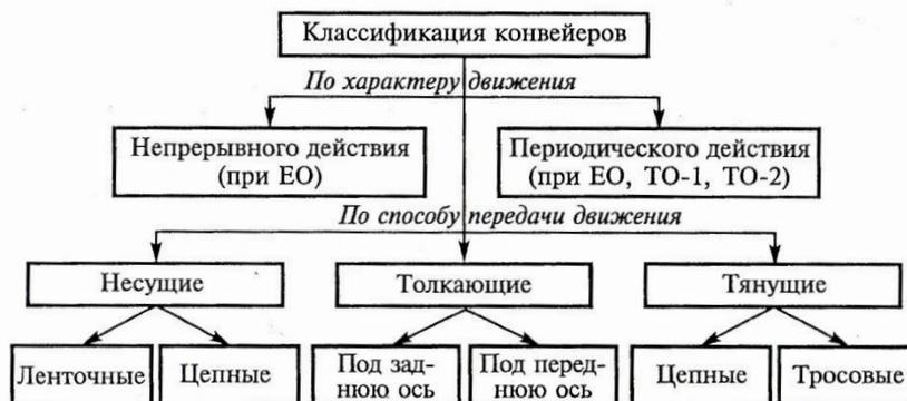
Рисунок 11 - Классификация конвейеров
