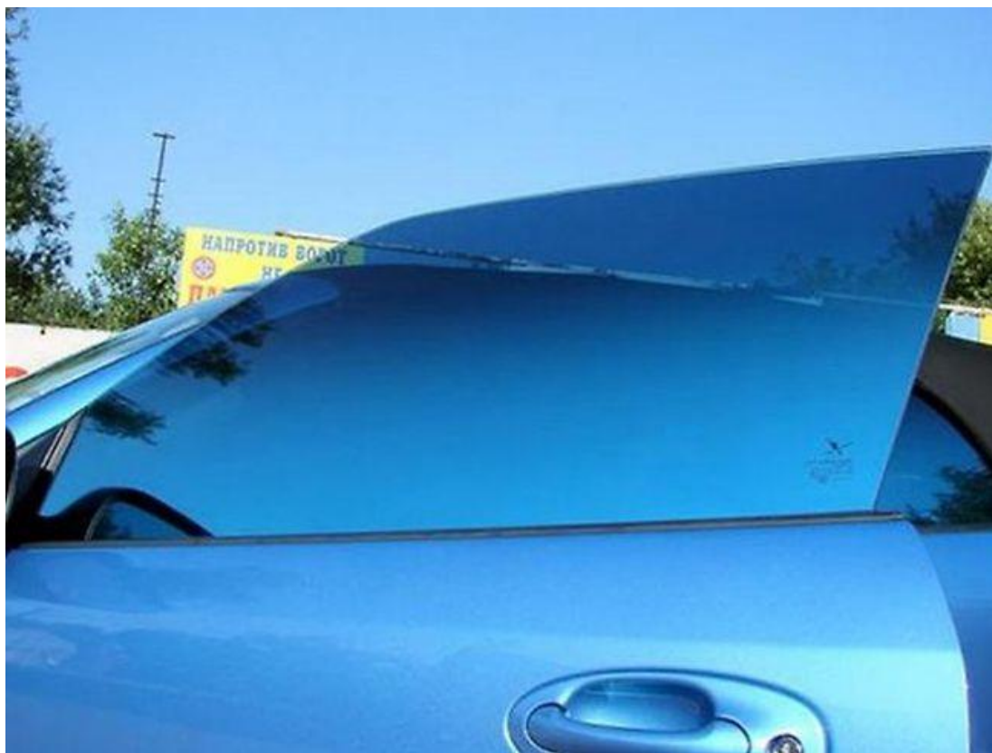
Рисунок 4.6 – Тонировка,нанесённая методом напыления
