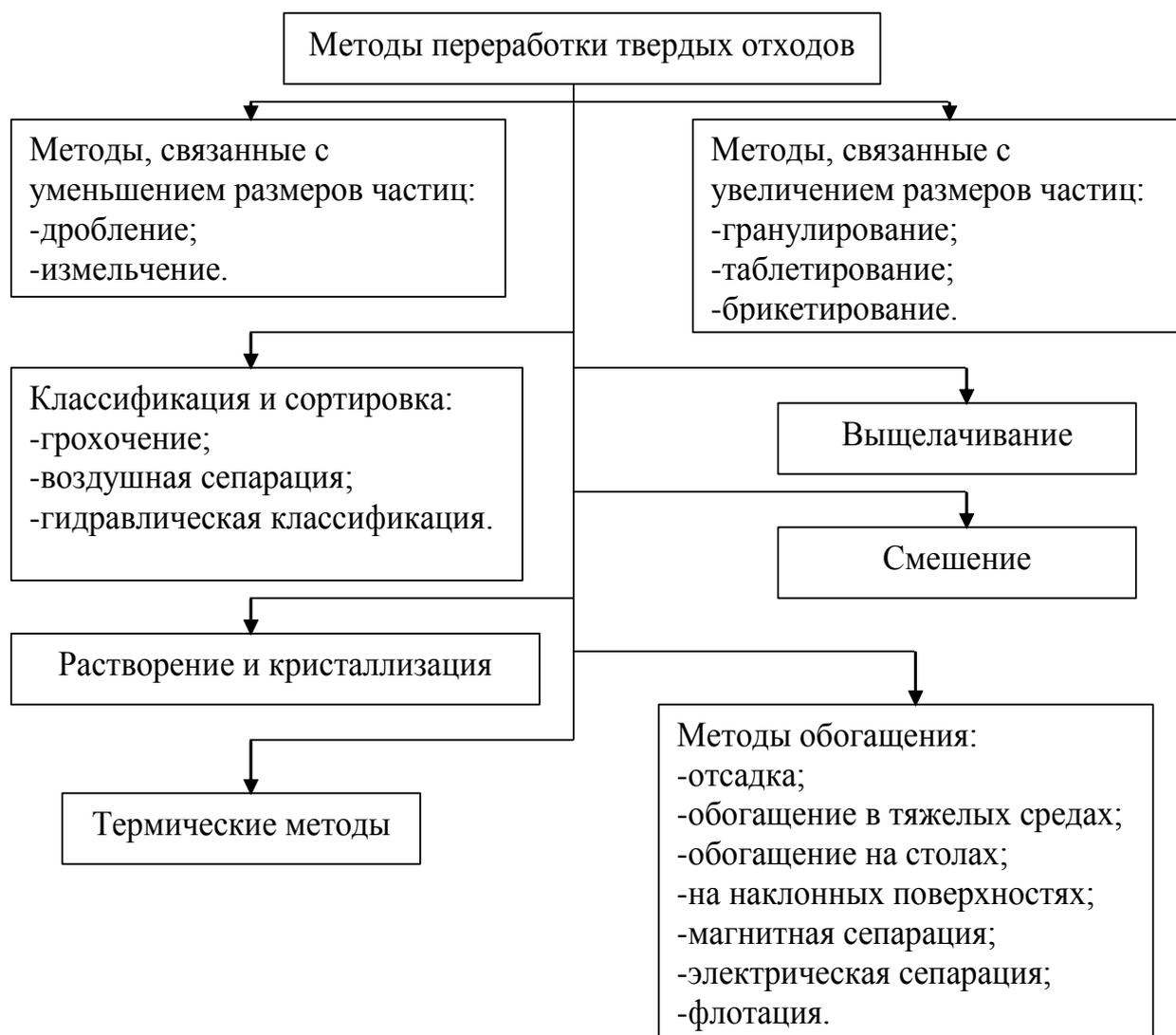
Рисунок 4.37 – Классификация методов переработки твердых отходов
