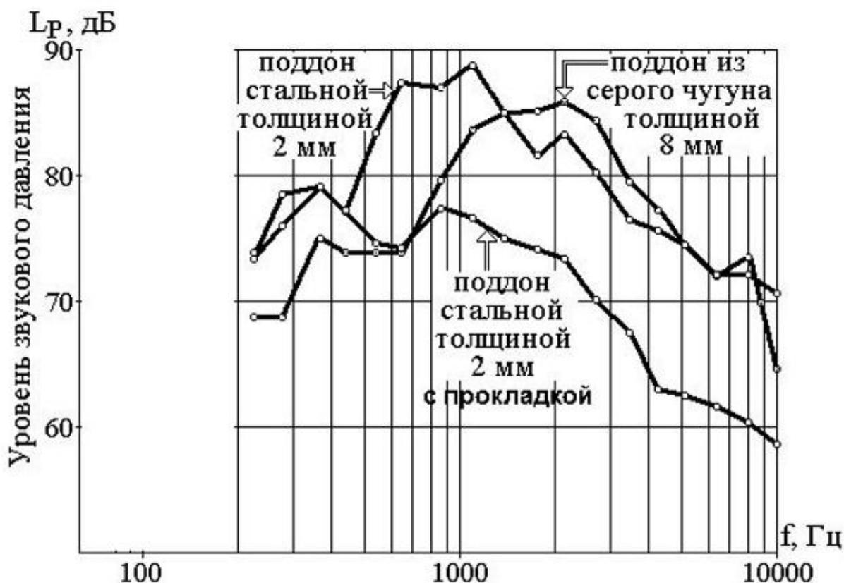
Рисунок 4.10 – Снижение шума от масляного поддона при различных вариантах его крепления к картеру двигателя
