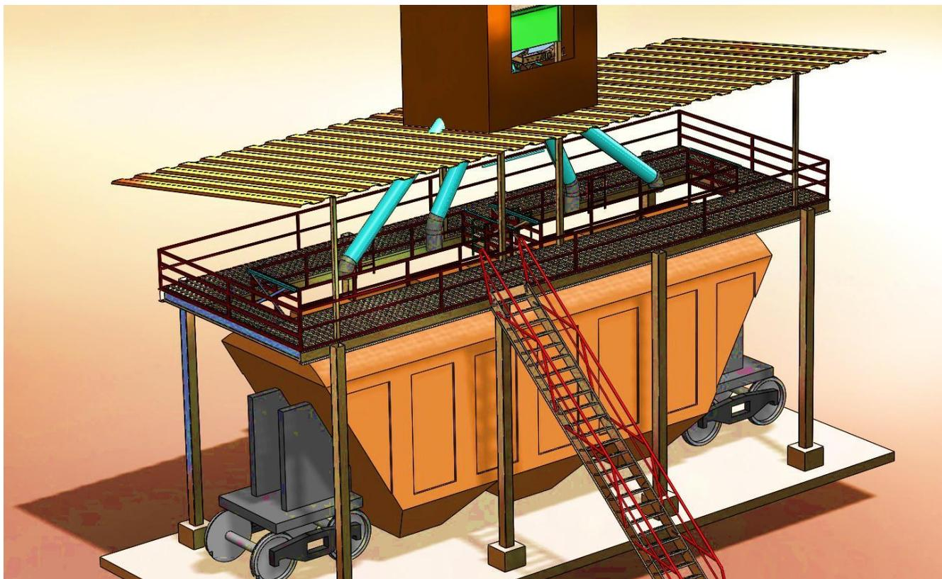
Рисунок 4.1 - Устройство для отгрузки зерна через люки в крыше вагона
