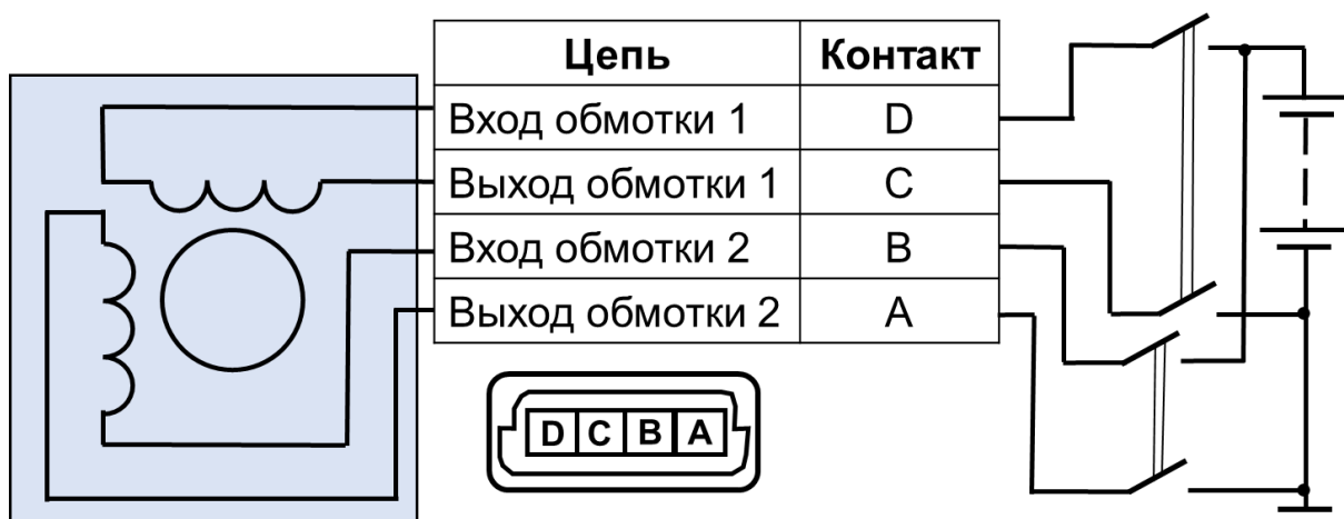
Рисунок 12 – Схема подключения регулятора холостого хода
