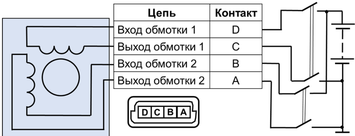
Рисунок А.12 – Схема подключения регулятора холостого хода
