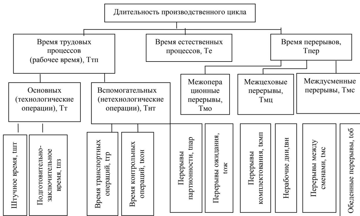
Рисунок 6.2 – Структура производственного цикла
