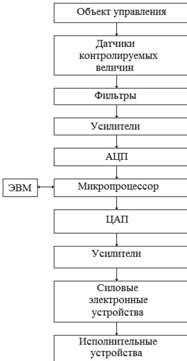
Рисунок 1- Структура системы управления объектом
