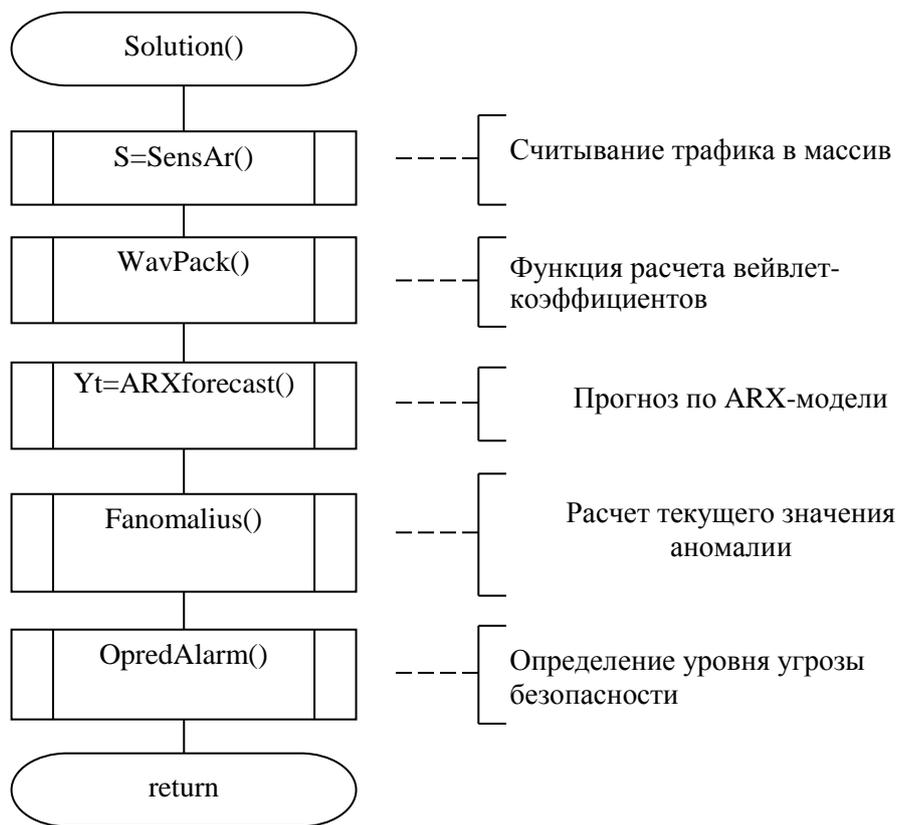
Рисунок 11.12 – Схема алгоритма функции определения уровня угрозы безопасности Solution()
