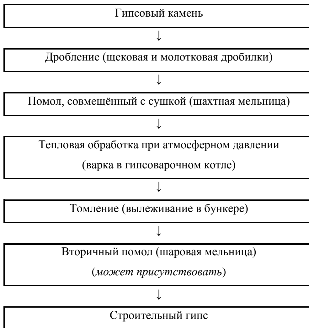
Рисунок 6.1 - Технологическая схема производства строительного гипса в гипсоварочных котлах
