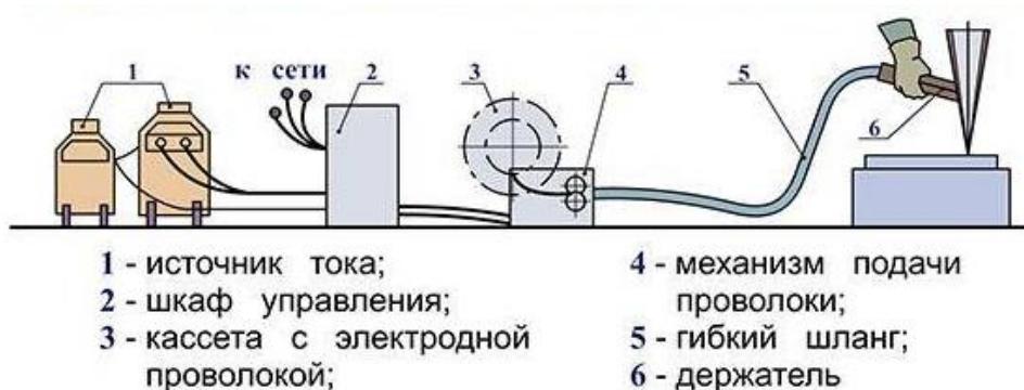
Рисунок 16 – Состав сварочного шлангового полуавтомата для сварки под флюсом
