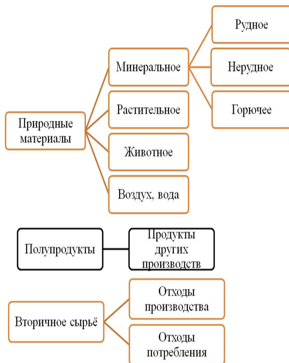
Рисунок 4 – Классификация сырья для химических технологий
