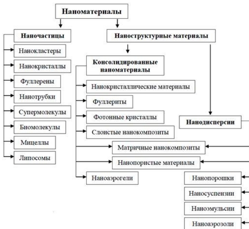
Рисунок 24 – Классификационная схема нанокристаллов
