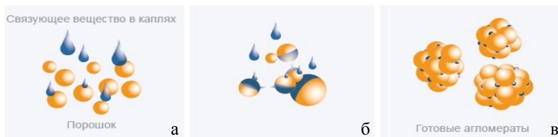
Рисунок 16 – Агломерация частиц в вихревом поле: напыление (а), увлажнение (б) и сушка (в)
