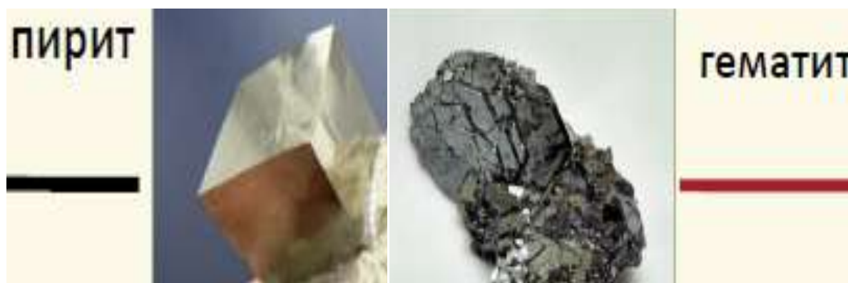
Рисунок 2.3 –Цвет черты минералов пирита и гематита
