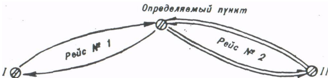
Рисунок 11 – Определение приращений силы тяжести на определяемом пункте относительно пунктов государственной гравиметрической сети РФ
