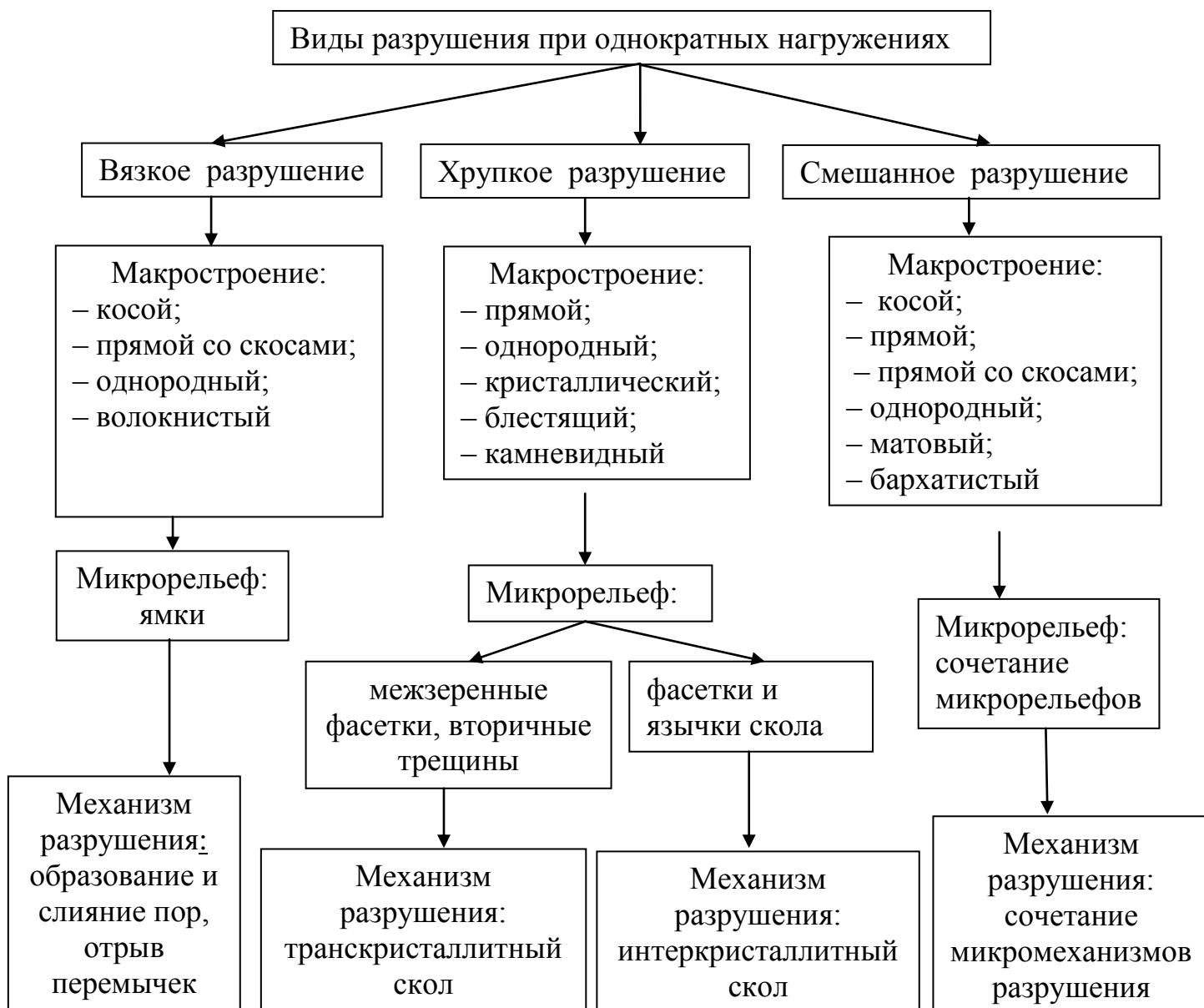
Рисунок 1.1 – Виды разрушения металлических материалов при однократных видах нагружения
