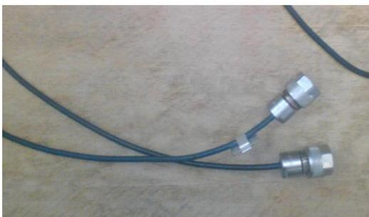
Рисунок 5 – Высокочастотные кабели
