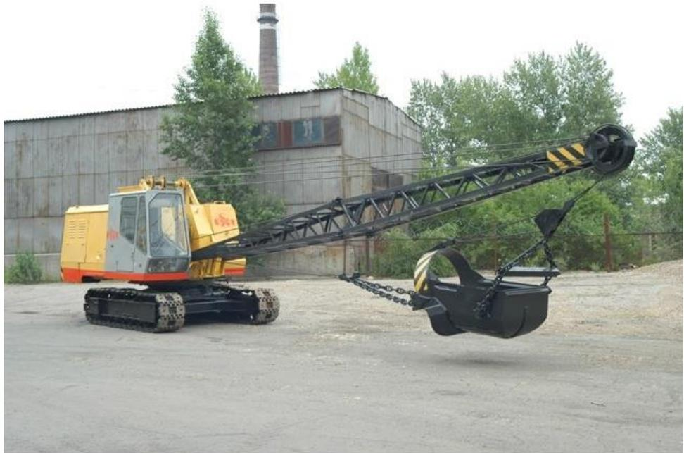
Zeichnung 3- Der Zugschaufelradbagger
